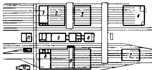
Фиг. 4. Вагоносборная мастерская: 1—тендерная; 2—сборная пассаж. ваг.; 3—малая; 4—сборная пассаж. ваг.; 5—кузница; 6—столярная; 7—малая; 8—деревобделочная; 9—сборная ваг.; 10—контора; 11—силовая станция.
